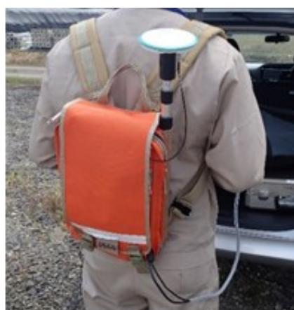
図1 歩行サーベイ機器の一例 （写真は KURAMA-II）
