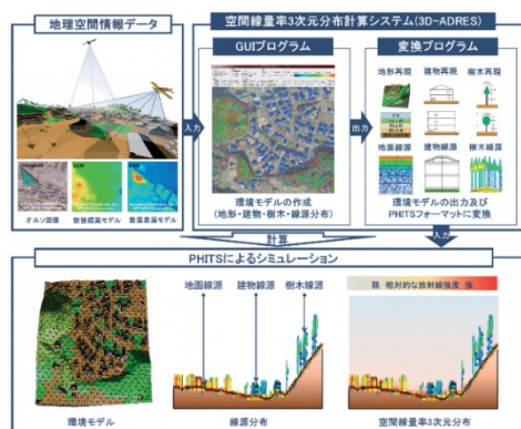
図1 3次元空間線量率分布解析システム（3D-ADRES）の概要および計算手順
