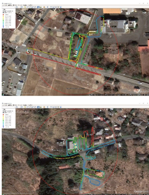
図 1 モニタリングポスト周辺の空間線量率マップの例
