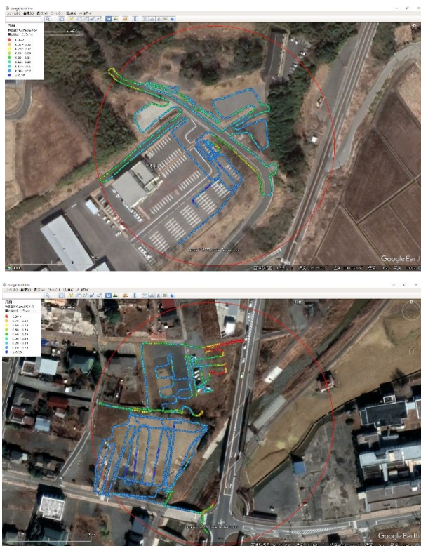
図 1 モニタリングポスト周辺の空間線量率マップの例
