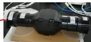
20 mm 厚の板状のプラスチックシンチレータを光電子増倍管ではさんだもの
