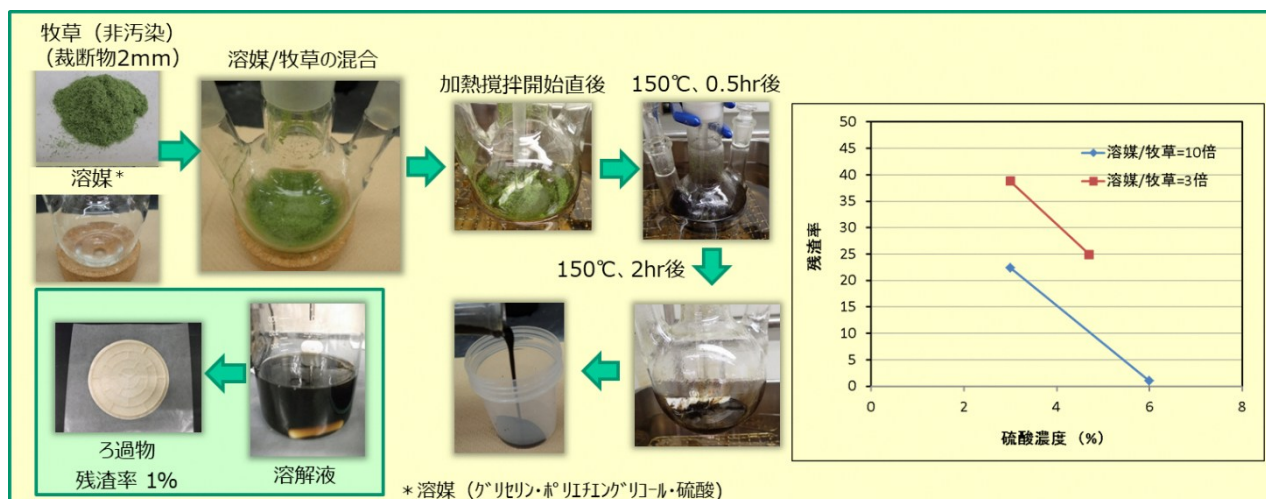
図1 酸触媒存在下のグリセリン加溶媒分解法による牧草の分解試験と残渣率に及ぼす硫酸濃度の影響
