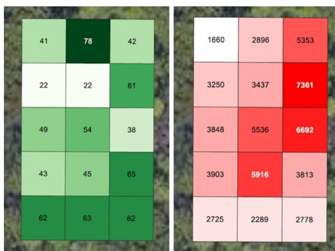
図2 調査地Cのリター（左）と土壌（右）のセシウム137濃度の分布 [Bq/kg-乾重] （上部が林縁、下方が森林内部）
